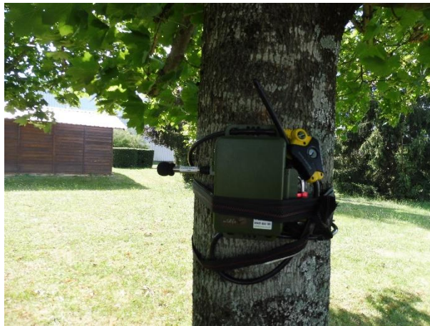
Photo 21 : Pose d'un SM4 sur les emprises du site (©IEA)
